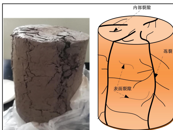
图3 分散性黏土样品冻融循环3次后大变形破坏状态
